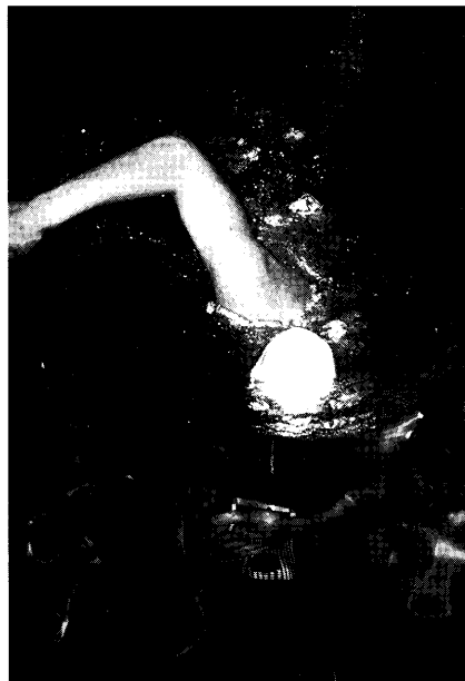
図2 MAD systemを利用した水抵抗測定。被験者はパッドを推して前方に進む。
